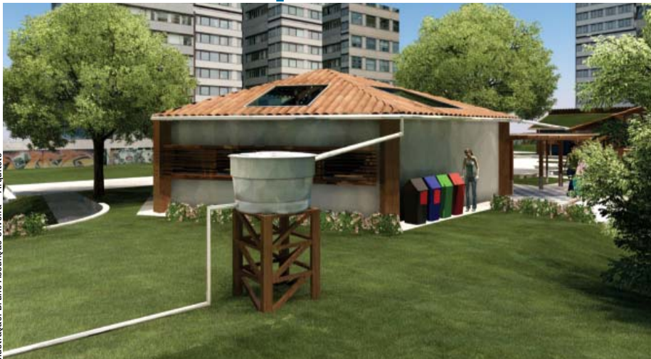
Projeto de sistema de captação de água de chuva em escola
