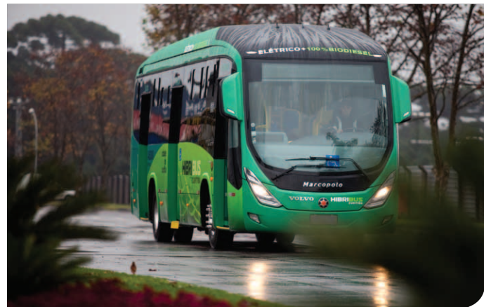
Sistema de ônibus híbridos, com motores elétrico e a diesel, é a aposta para reduzir poluição atmosférica em Curitiba
