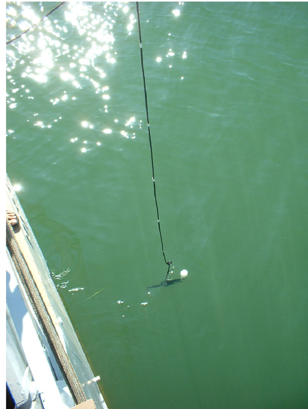
Fig. 21 – Metodologias para a determinação da transparência da água (disco de Secchi), turbidez (turbidímetro), sólidos em suspensão (filtros usados no método gravimétrico) e radiação solar na coluna de água de um reservatório (sensor de um radiômetro LiCor. Fotos: RMPC.
