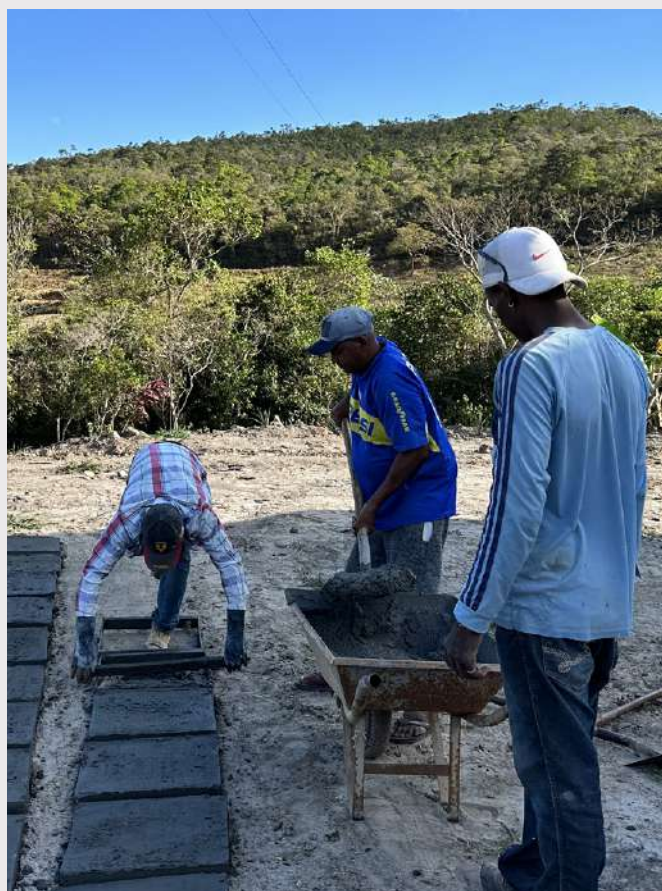
Fabricação das placas de levante na comunidade quilombola de Queimadas, na divisa entre Serro e Santo Antônio do Itambé.
