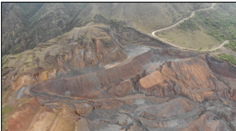
Figura 5 - Imagem de drone ANM - Visão da área degradada na porção superior da mina com a estrada de acesso ao Pico Belo Horizonte, detalhe para pilhas de produto apoiadas sobre taludes onde se faz necessário a correção geométrica dos mesmos.
